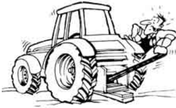
Fig. 1.12 Trekker met aftakas en losse kleding
