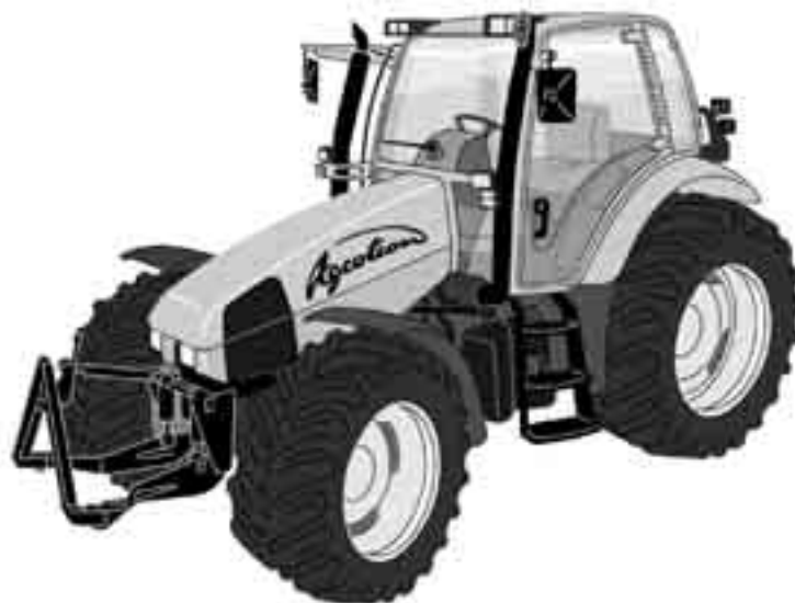
Fig. 2.3 Trekker met schuin aflopende motorkap (Deutz-Fahr Agrotion)
