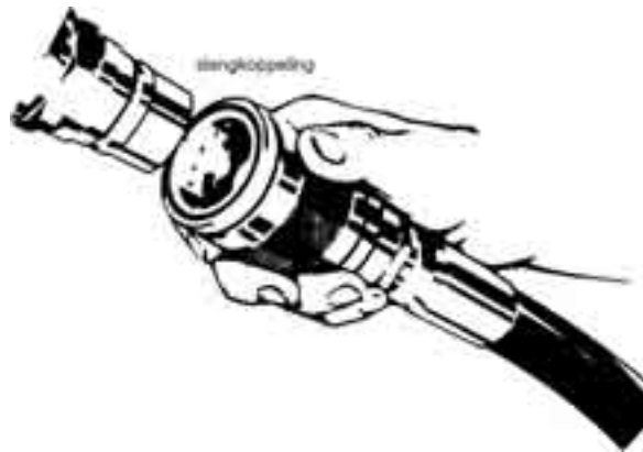
Fig. 13.3 Het aankoppelen van een hydrauliekslang met snelkoppeling
