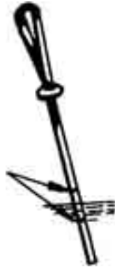
Fig. 18.44 Het oliepeil staat tussen maximum en minimum.
