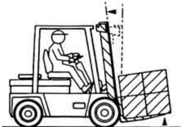
Fig. 18.22 Mast achterover kantelen
