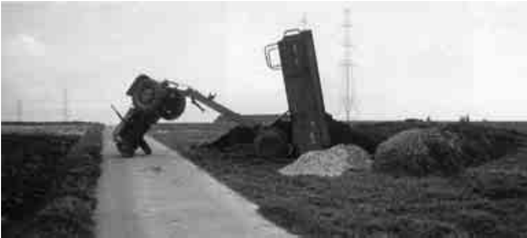
Fig. 9.3 Trekker die wordt opgetild, doordat de lading is blijven hangen
