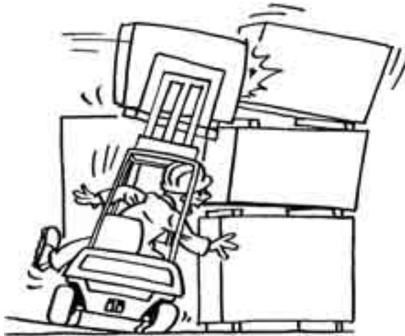
Fig. 18.42 Heffen, stapelen of keren op een helling kan het omslaan van je heftruck veroorzaken.
