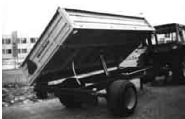
Fig. 10.6 Driezijdig kippende kipwagen
