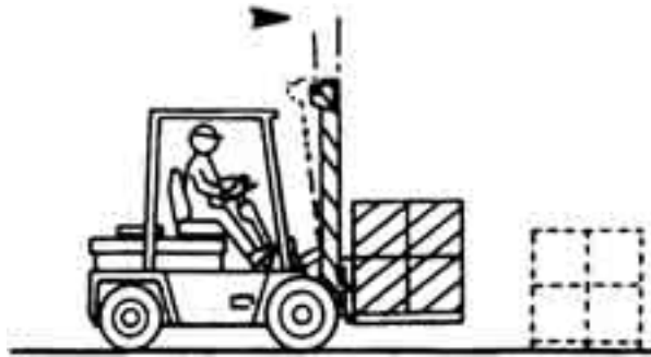
Fig. 18.26 Mast voorover bij lossen
