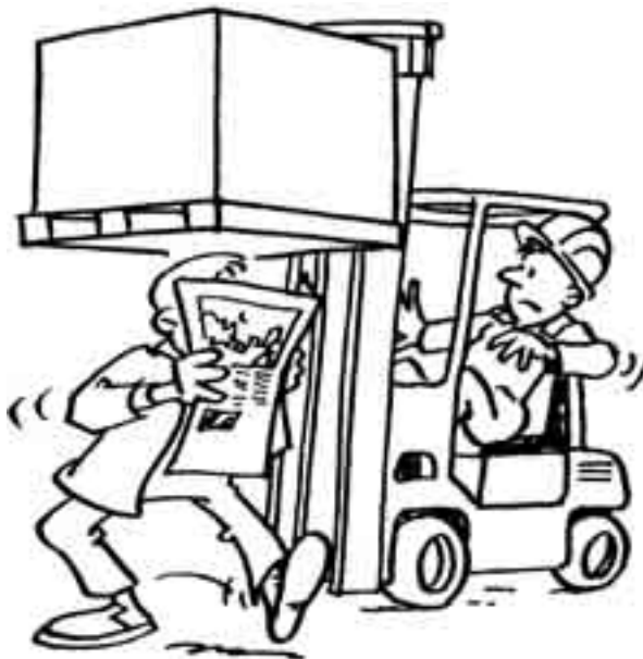
Fig. 18.31 Sta nooit toe dat er iemand onder een opgeheven last doorloopt.
