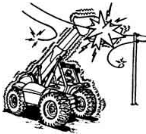
Fig. 19.12 Kijk uit voor laaghangende elektriciteitskabels.
