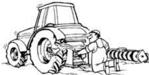
Fig. 1.13 Trekker met draaiende aftakas en wegvliegende hand
